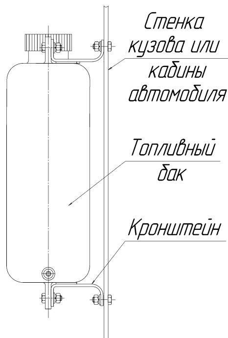
Рис. 6- Установка топливного бака на автомобиль.
